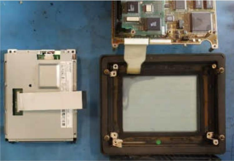
**UNSCREW & UNPLUG THE BACKLIGHT ASSEMBLY TO TAKE IT OUT OF THE LCD.**
