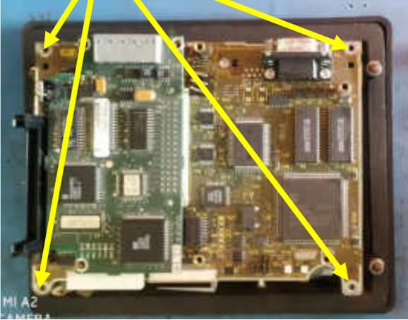
UNPLUG THE LCD RIBBON CABLE FROM THE BOARD.
